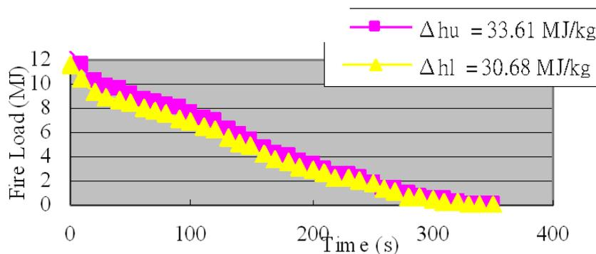
Fig. 14: 2-propanol fire load
