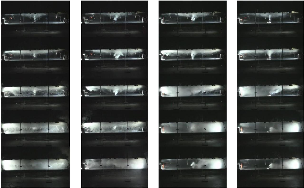
(a) No Longitudinal ventilation      (b) Velocity =  $0.5 \text{ ms}^{-1}$       (c) Velocity =  $1 \text{ ms}^{-1}$       (d) Velocity =  $1.5 \text{ ms}^{-1}$
