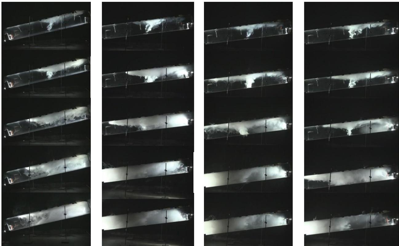
(a) No ventilation      (b) Velocity =  $0.5 \text{ ms}^{-1}$       (c) Velocity =  $0.55 \text{ ms}^{-1}$       (d) Velocity =  $0.7 \text{ ms}^{-1}$
