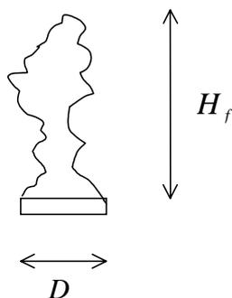
Fig. 3: Height of turbulent diffusion flames
